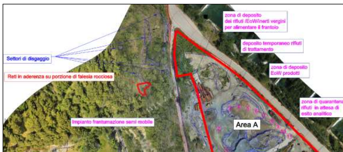
Planimetria delle opere di protezione
