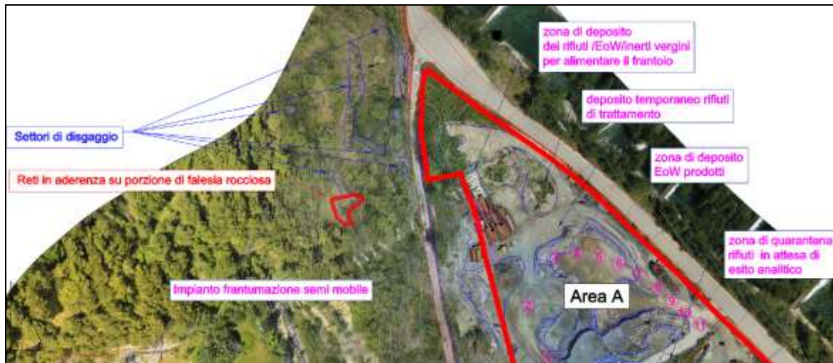
Planimetria delle opere di protezione
